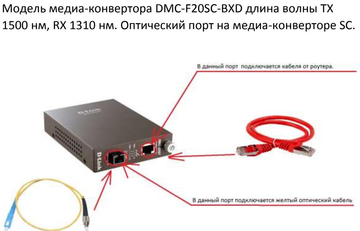
Схема подключения роутера через оптический медиаконвертер
